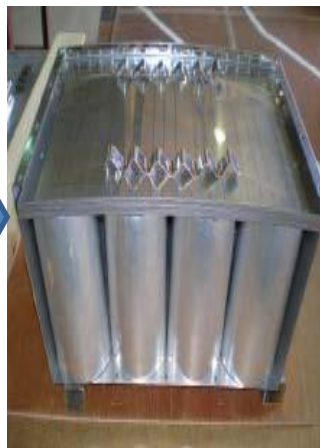
防護材の内部
